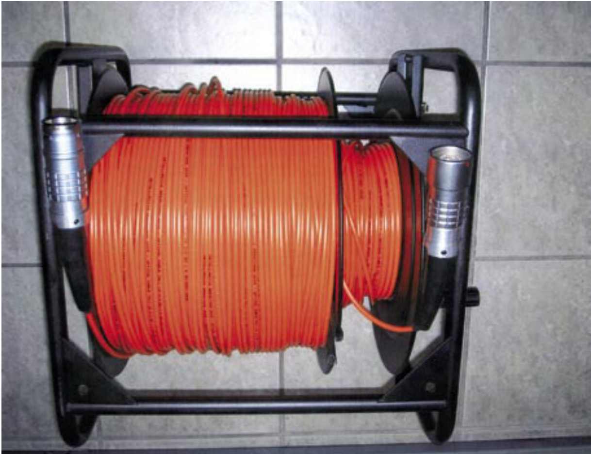
fig. 14 Bobina di soccorso per OPGW
